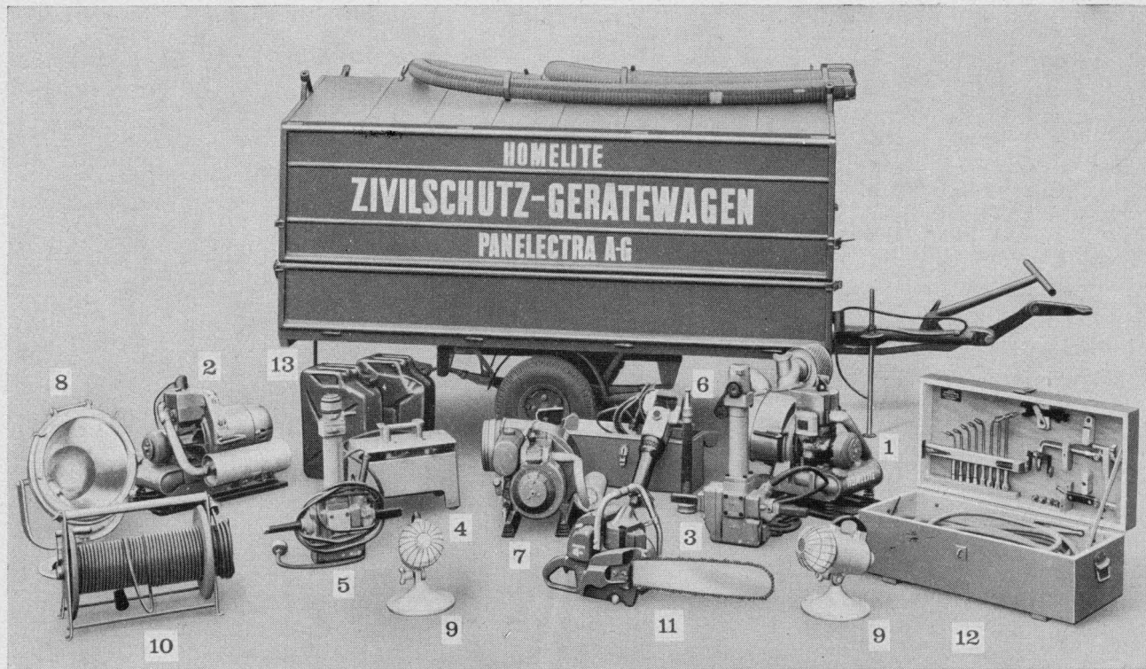
Einachs-Anhängewagen mit folgender Ausrüstung: Wasser- und Schlammpumpe 3". Hochfrequenz-Notstromgruppe, Rauch- und Gasabzugsgerät, 1 grosser und 2 kleine Scheinwerfer. Einmann-Kettensäge. Bosch-Homelite-Hochfrequenz-Aufbruchhammer, Bohrhammer Bauhammer, Bosch-Gebläse für Bohrhammer. Kabelrolle. Kompl. Maxim-Schweissanlage und 2 Benzinkanister.
